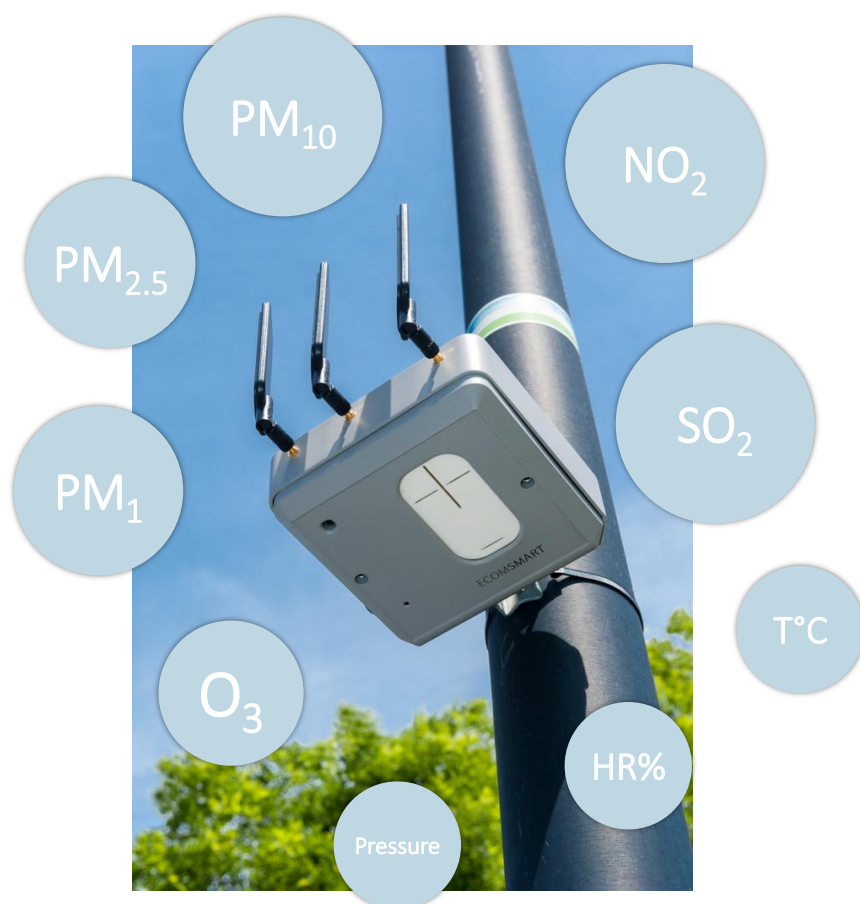
ECOMSMART Station connectée de mesure de l'air extérieur
