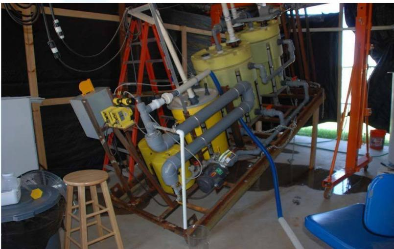
*Test de résistance à l'inclinaisons sur le système*
