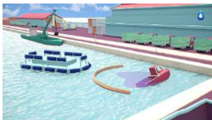
Pompage fixe, mobile, barge de dépollution
