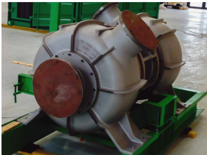
Turbine ORC et son conteneur à l'atelier d'AQYLON en Ile-de-France
